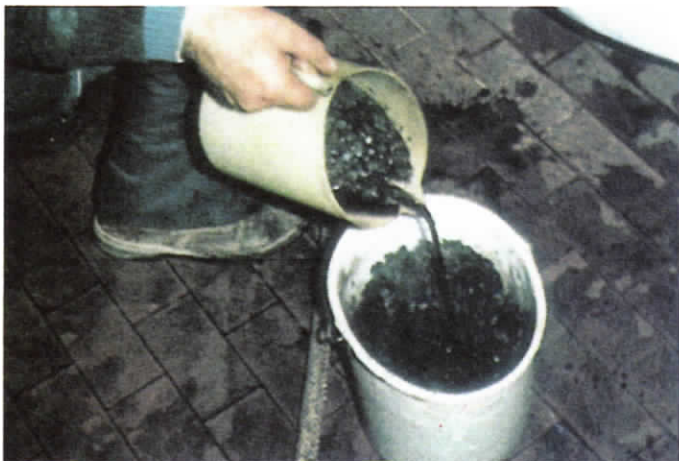
Particolare del gruppo che mostra una piccola parte dei sedimenti catturati in un impianto misto di riscaldamento e condizionamento
